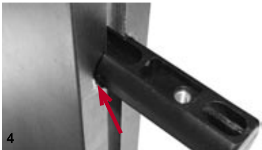
3-4 Posizionare il connettore nel montante (foro Ø 25x66 mm) inserendo la parte fissa fino al segno di posizionamento, facendo comunque attenzione che la base del connettore si trovi sempre verso lo specchio della porta.
